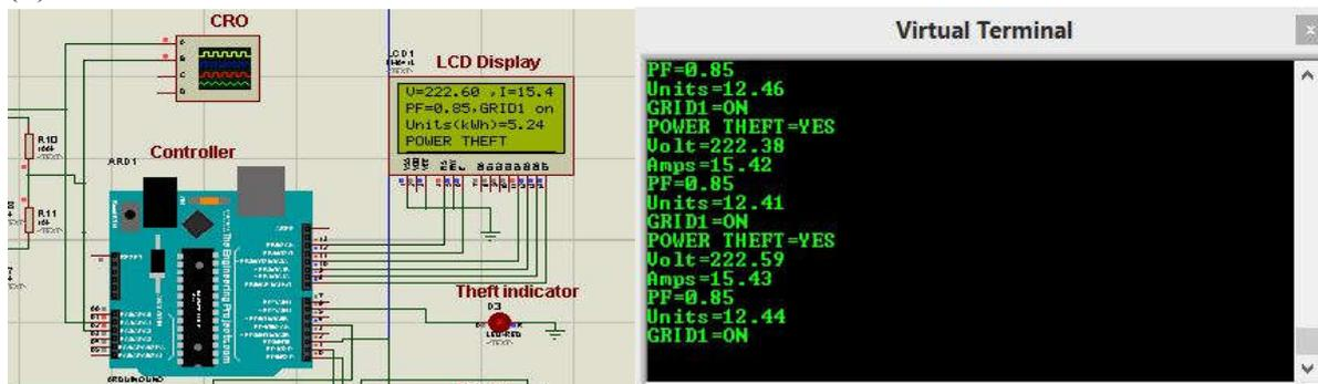
Figure 3.1.7a) LCD DISPLAY AT POWER THEFT b) VIRTUAL TERMINAL READINGS AT POWER THEFT
