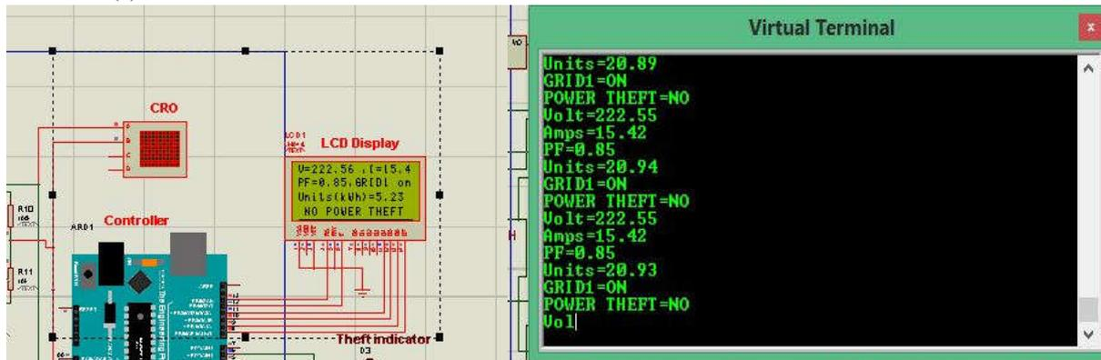
Figure 3.1.6 a) LCD DISPLAY AT NO POWER THEFT b) VIRTUAL TERMINAL READINGS AT NO POWER THEFT
